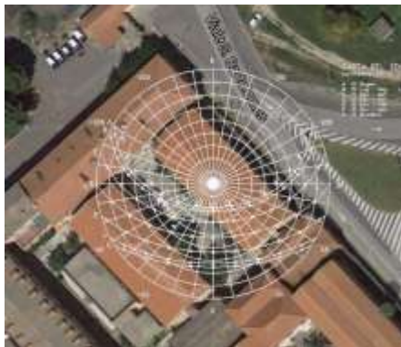
Studio termografico delle murature della Caserma Cascino a Cagliari. Individuazione dell'ora di rilievo
