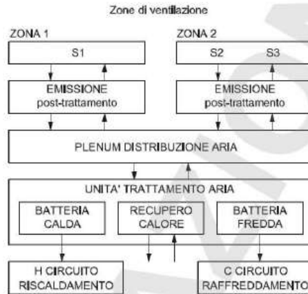
figura 4 Suddivisione di un sistema di ventilazione
